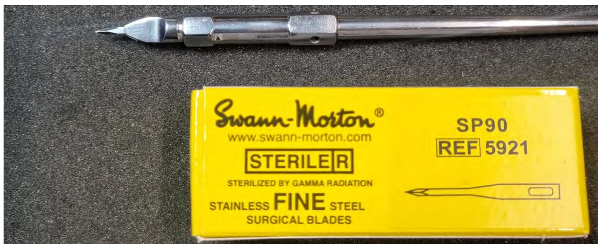
4. Sekundaarsete värvikihtide eemaldamiseks kasutati skalpelli.
