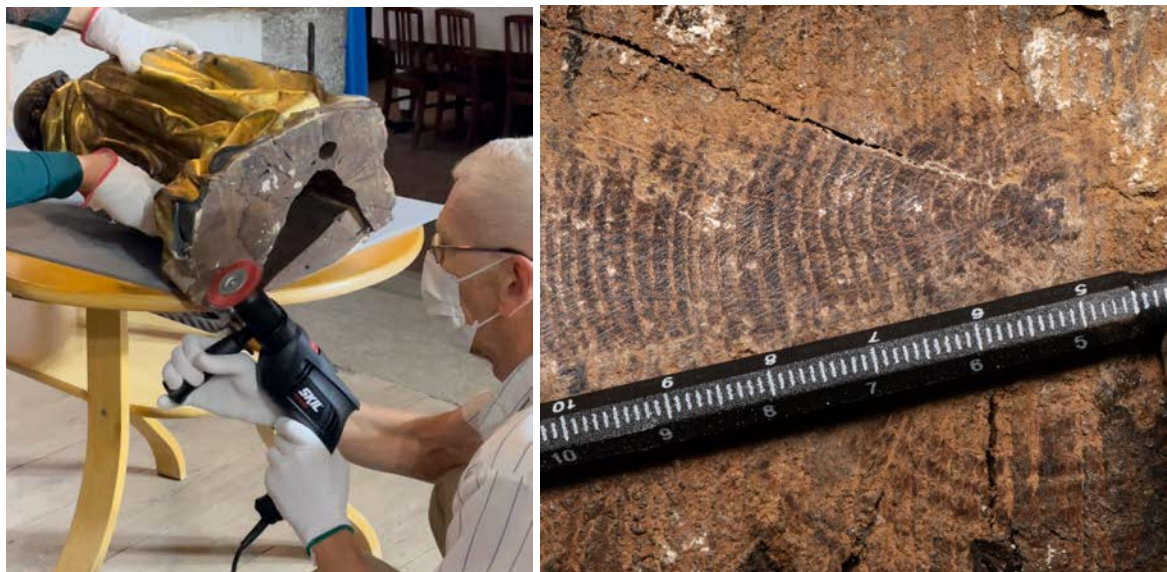
Fotod 10 ja 11. Dendrokronoloogilise uuringu ettevalmistamine. Vasakul – aastarõngaste välja puhastamine Donaatori skulptuuril; paremal – Elisabethi figuuri aastarõngaste pildistamine mõõtketiga.
