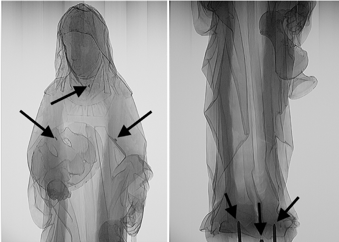
Fotod 64 ja 65. Röntgenfotod Püha Elisabethi skulptuuri metallkinnituste ja naelte asukohtadest. Fotod: MTA.
