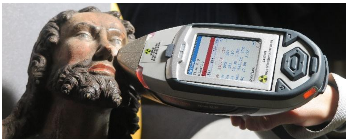
Foto 9. Portatiivse XRF-ga mõõtmine Apostel Filippuse näol.
