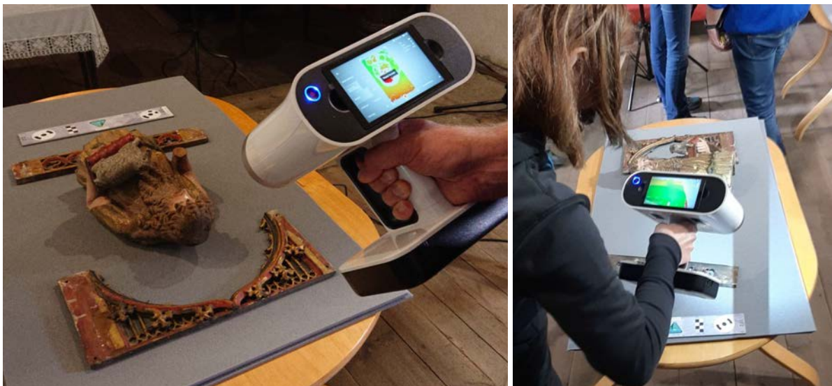
Fotod 1 ja 2. Bluelight LED-tehnoloogiaga käsiskanner Artic Leo, millega skanneeriti kujudest esmane 3D mudel.
