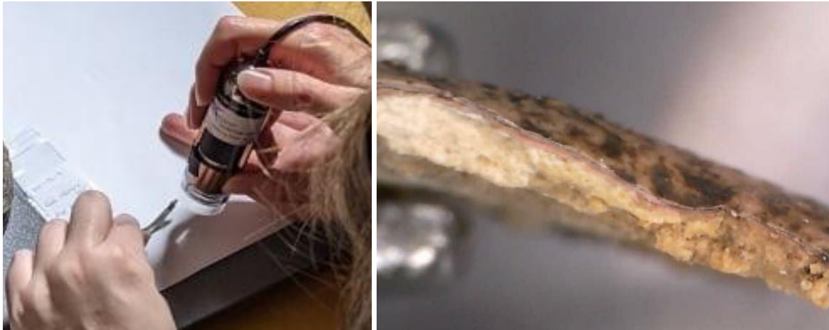
Fotod 101 kuni 102. Skulptuurilt eraldunud pildikihi tüki vaatlemine Dino-Lite mikroskoobiga; Skulptuurilt eraldunud pildikihi tüki Dino-Lite mikroskoobist vaadelduna.
